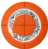
Essai d'érosion de cavitation d'un revêtement
