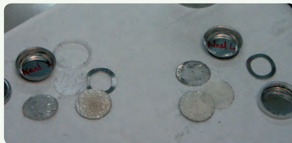
Cellule symétrique Li vs. Li désassemblée après tests de cyclabilité.
