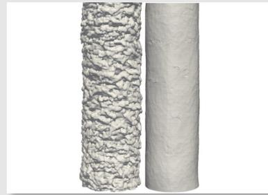
État de surface brut de fabrication et après traitement de grenailage ultrasonique.
