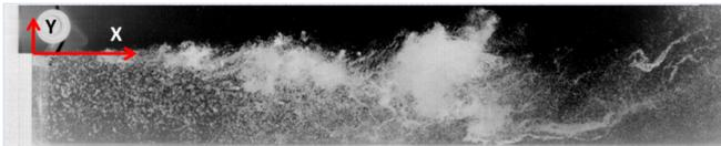
**Figure 2 :** Exemple d'écoulement de marche descendante cavitante obtenu (l'écoulement est de gauche à droite).
