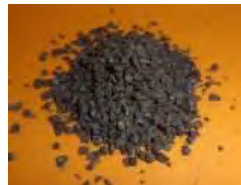
Figure 3 : mélangeur à rouleau en Boîte à gant et feedstock de NdFeB réalisé avec de la poudre monocristalline CEA5 \mu m
