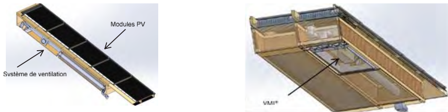
Figure 6 : coupes et vue de dessous du caisson 2 avec modules PV et système de ventilation
