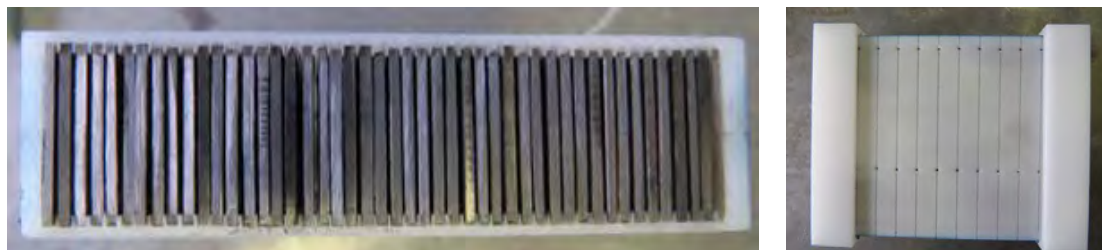
Figure 6 : Vues du prototype du régénérateur magnétique actif
