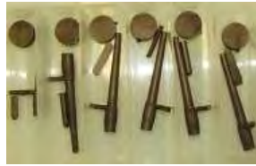
Figure 2 : Pièces de NdFeB injectées avec la poudre MQ 5 \mu m
