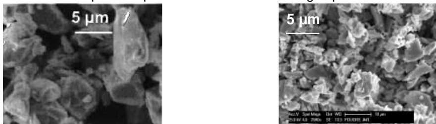
Figure 1 : Morphologie de la poudre MQ à gauche et CEA à droite (d50 = 5 \mu\text{m} ).
