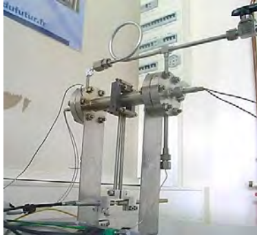
Figure 1 : Porte-échantillon et capteur LVDT
