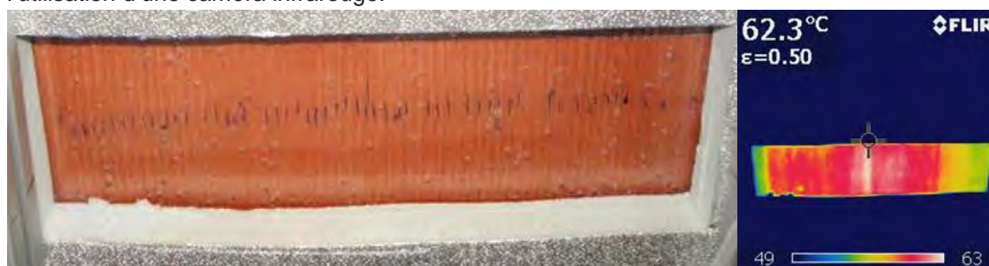
Figure 6 : (a) Visualisation du passage de bulles dans l'ensemble des canaux du capteur et (b) de la répartition homogène de la température dans la largeur du capteur.
