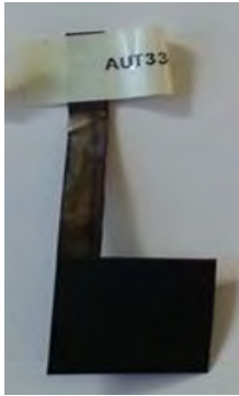
Figure 3 : Electrode avant montage en batterie pochette, courbe de cyclage obtenue à partir de l'électrode précédente
